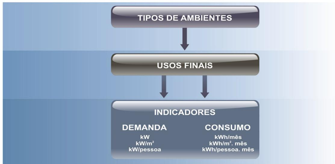
**Figura 7: Esquema \_ Indicadores dos ambientes desagregados por uso final**
