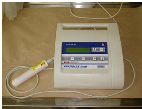
Figura 2 –Equipamento Laser Physiolum Dual da Bioset – Al-Ga-As com comprimento de onda de 785 nm.
