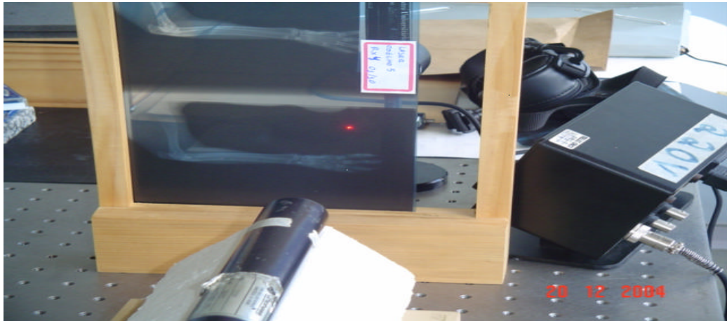
Figura 4 - Demonstração da incidência do laser na chapa.
