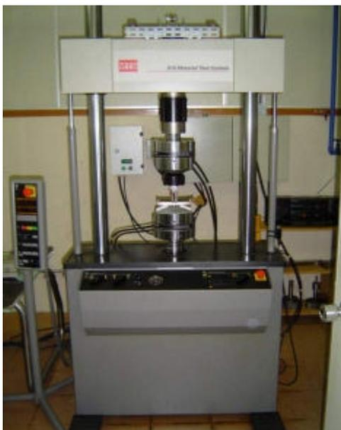
Figura 4 - Máquina de ensaios servo-hidráulica MTS utilizada para a realização dos ensaios mecânicos de flexão.
