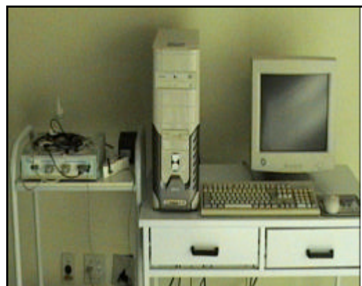
Figura 04: Sistema para a coleta do sinal elétrico dos músculos.
