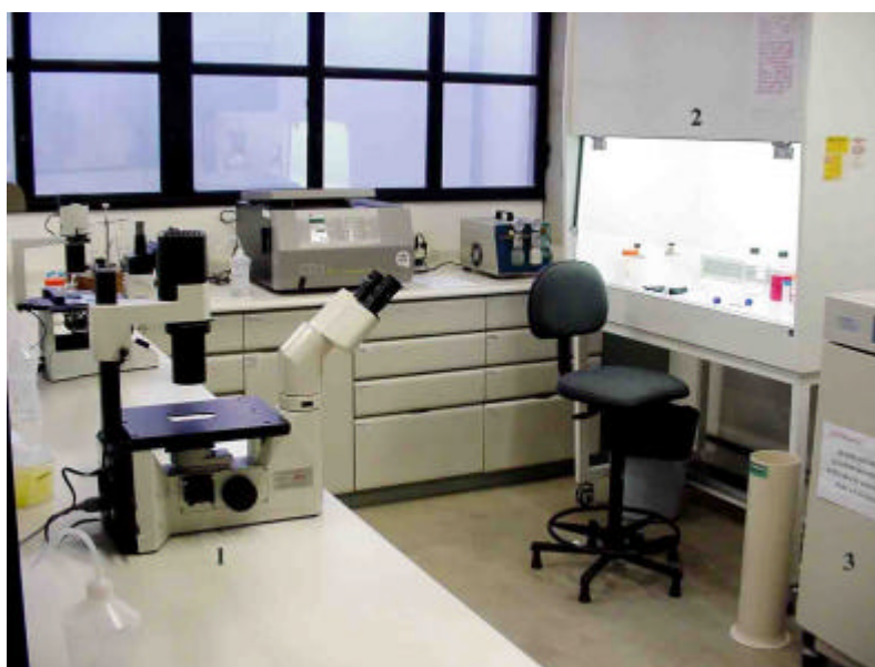
Figura 2 - Laboratório de Cultura de Células da Univap : observar 1 - microscópio invertido; 2 - fluxo laminar; 3 - estufa microbiológica de cultura (Moura, 2006)
