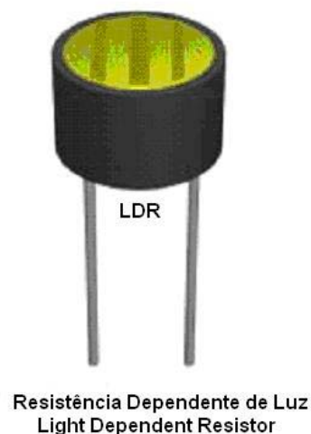
Figura 3: Desenho de um LDR. Pode-se observar que o formato dele é cilíndrico, com duas pontas metálicas no extremo inferior.
