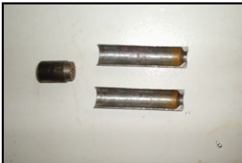
Figura 4 – Foto do recipiente usado no recobrimento de pinos e parafusos de aço com resina furfurílica, com tampa e duas faces.
