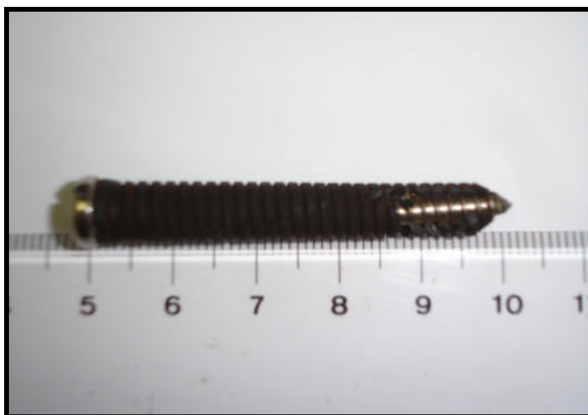
Figura 10-Falhas decorrentes do processo de usinagem.
