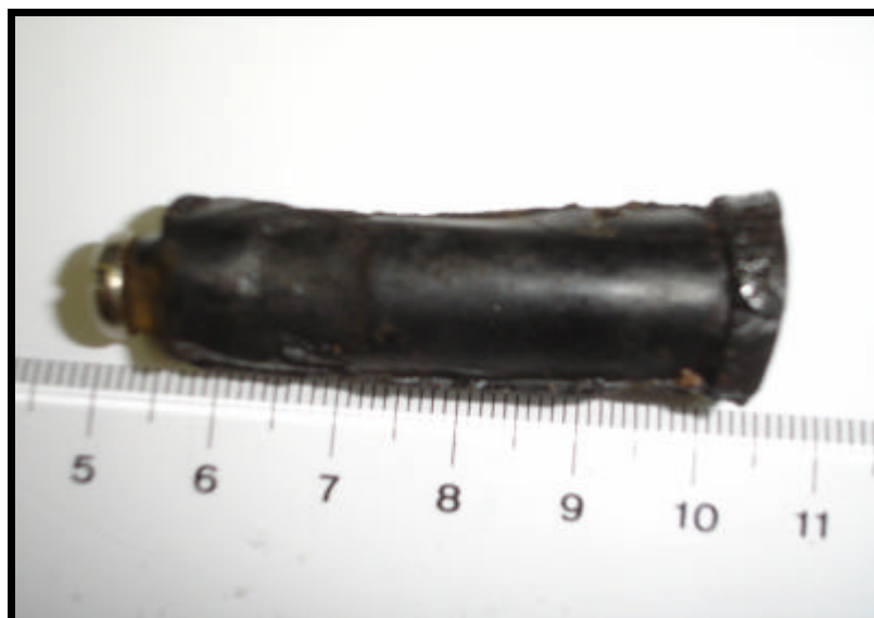
Figura 8-Aspecto da resina furfurílica polimerizada, cobrindo o parafuso de aço inox 316L.
