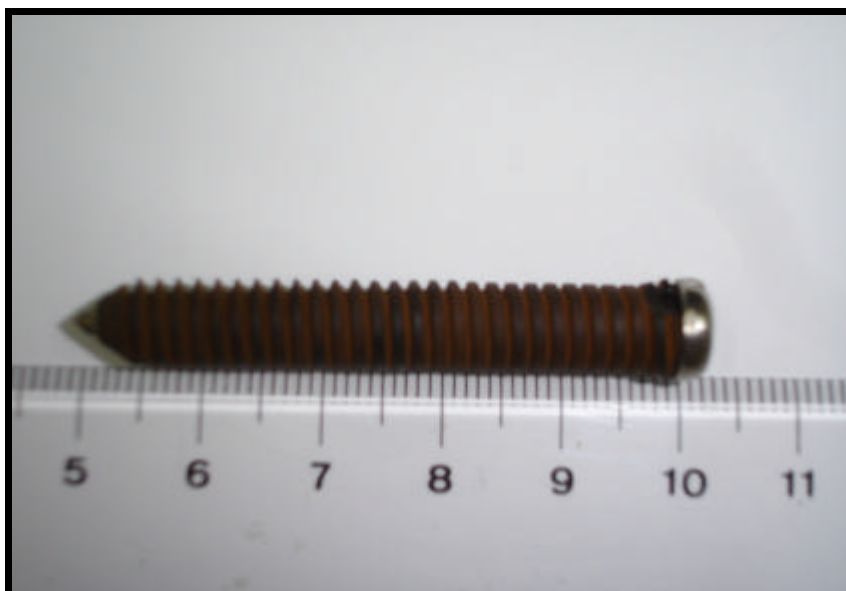
Figura 9- Foto do parafuso de aço inox 316L recobertos por resina furfurílica.
