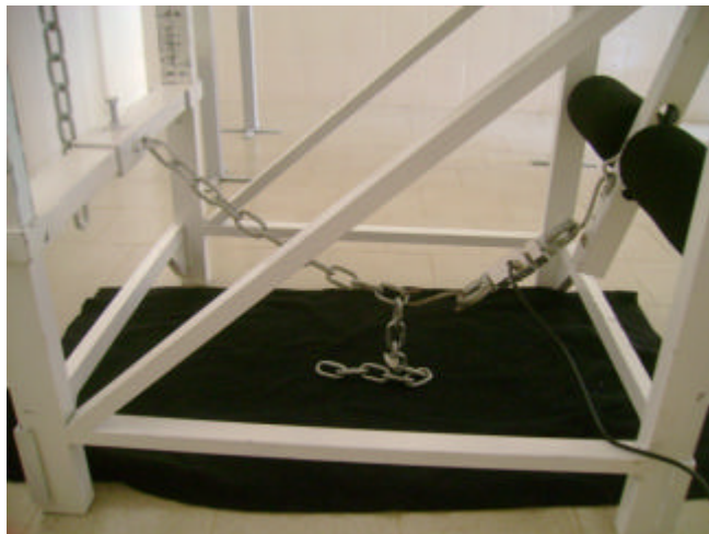
Figura 16 - Transdutor de força acoplado na cadeira extensora adaptada. Fonte: Arquivo pessoal
