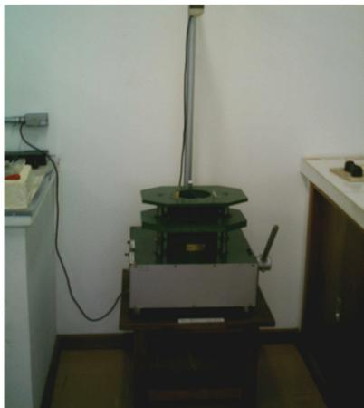
Figura 7 – Equipamento de impacto por queda de dardo (*Dard Drop*).
