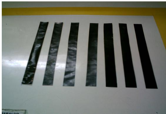
Figura 6 - Corpos de prova utilizados no ensaio de tração.
