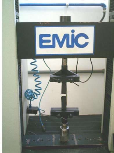
Figura 5 - Máquina Universal de Ensaio Marca EMIC-DL10000 utilizada no ensaio de tração.
