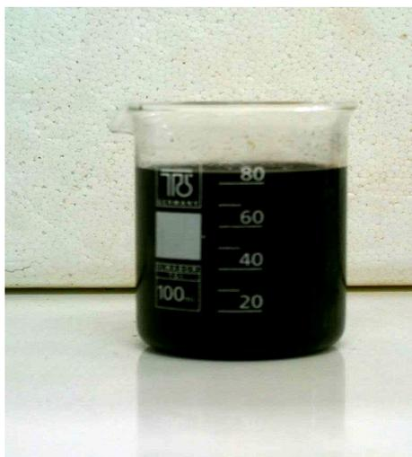
Figura 8 – Solução de serragem de couro ao cromo digerida.
