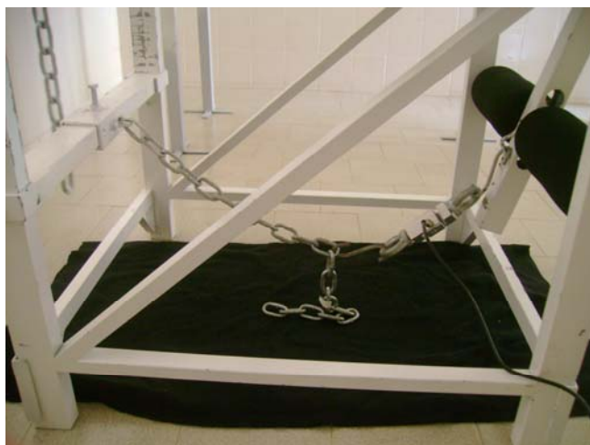
Figura 17 – Transdutor de força acoplado na cadeira extensora adaptada. Fonte: Arquivo pessoal
