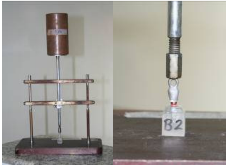
Figura 14 – Cimentação dos copings metálicos
