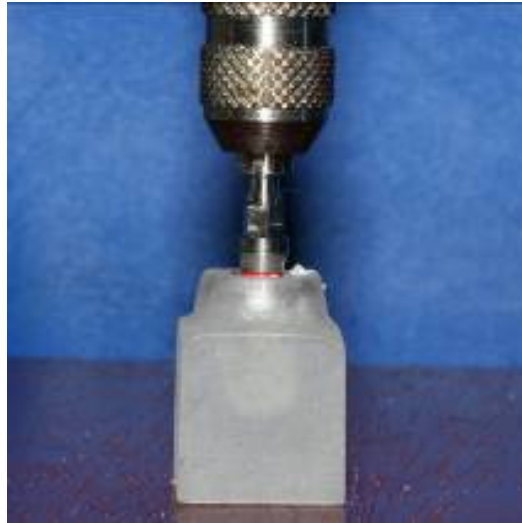
Figura 7 - Fixação da réplica no bloco de resina acrílica
