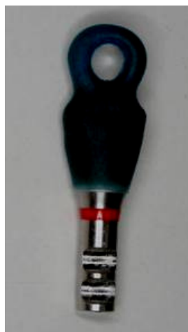
Figura 10 - Padrão de fundição sobre a réplica do implante
