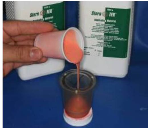
Figura 6 - Silicona vertida para copiar o bloco de gesso – obtenção da matriz
