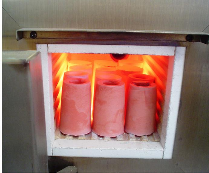
Figura 11 – Moldes sendo acondicionados no forno pré aquecido
