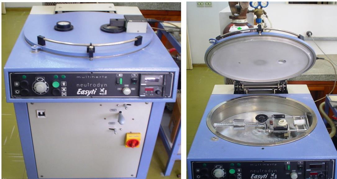
Figura 14 – Utilização da máquina de fundição por indução com ambiente controlado
