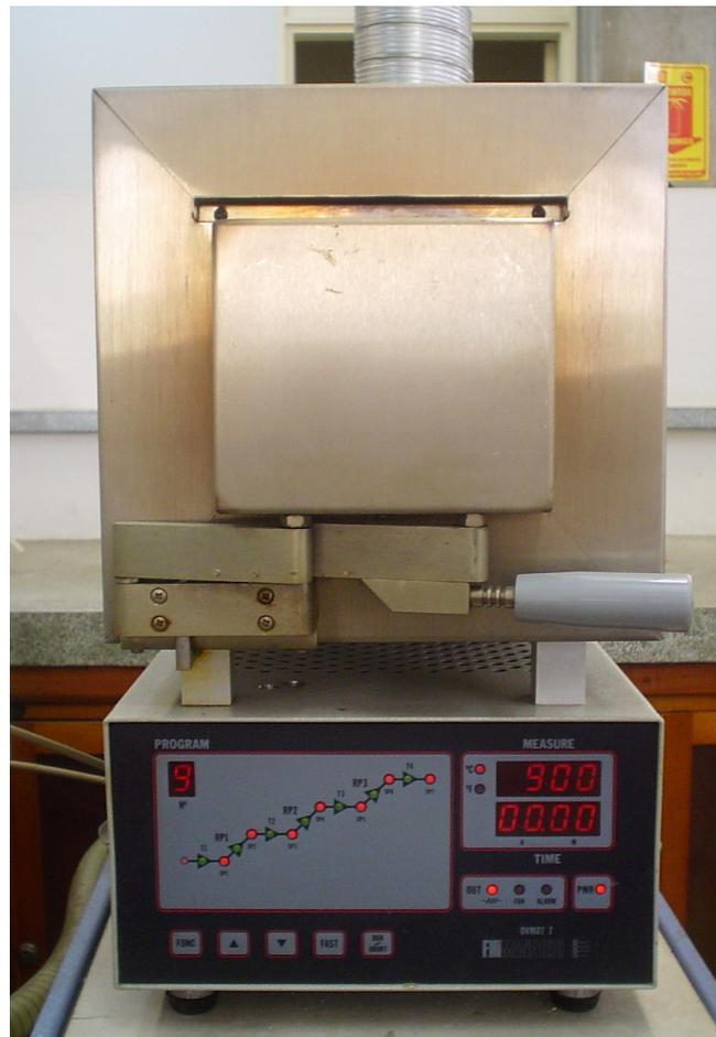
Figura 12 – Forno utilizado na eliminação da cera
