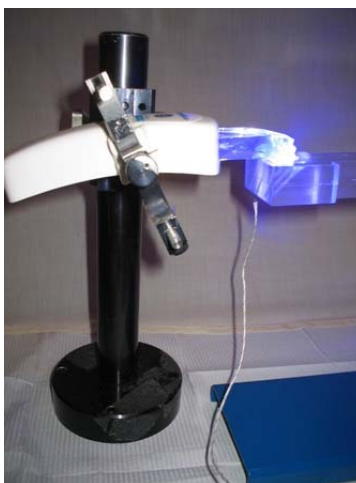
FIGURA 5 Arranjo experimental com o LED azul associado ao laser infravermelho.
