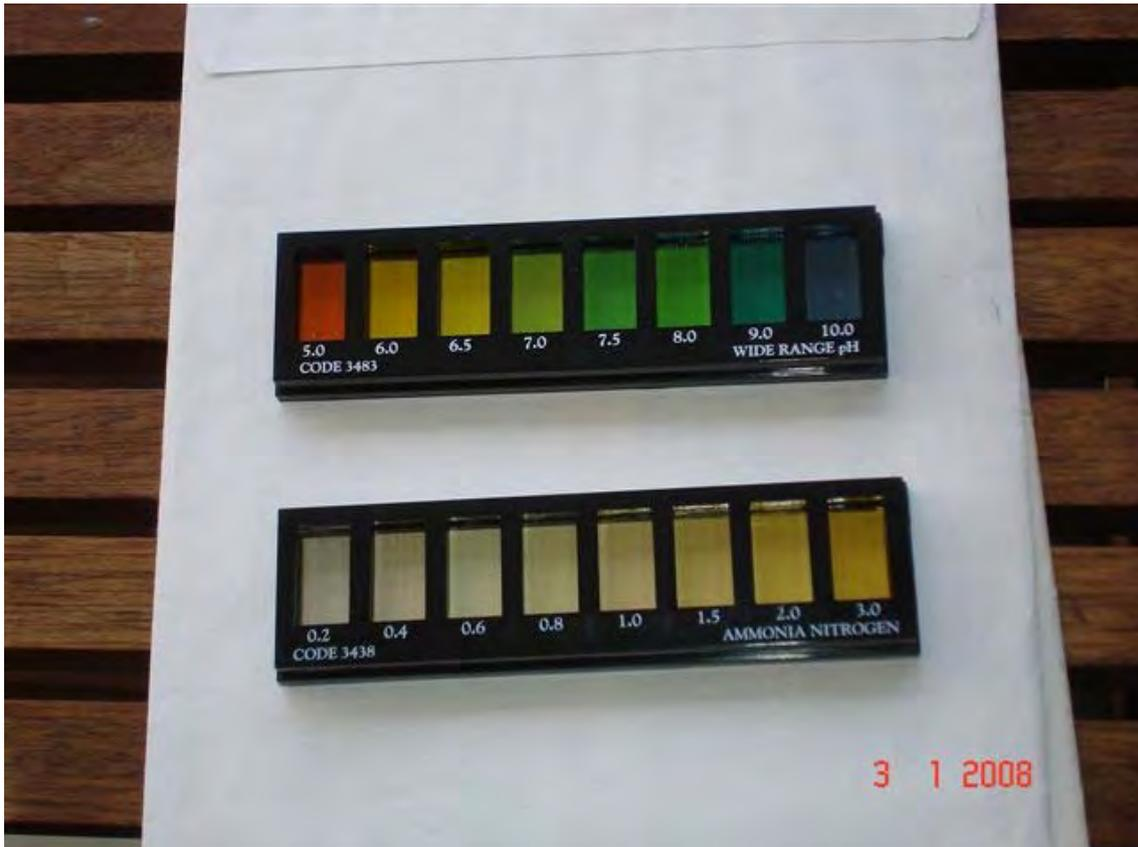
Figura 5: Escalas colorimétricas de pH e Nitrogênio-Amônia
