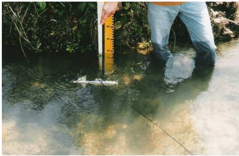
FIGURA 06 – Molinete hidrológico. AUTOR: SILVA, Emerson Malvino; 2006.
