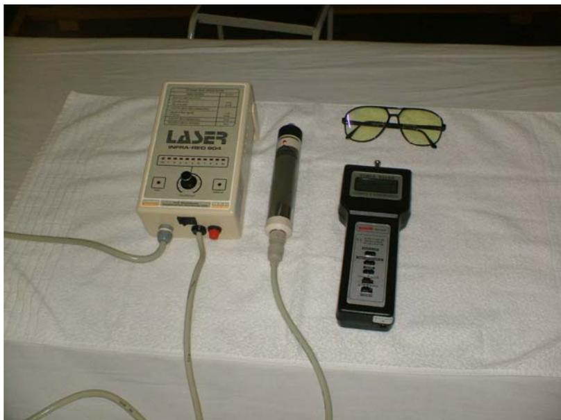
**Figura 7: Laser, algômetro e óculos de proteção para o laser.**
