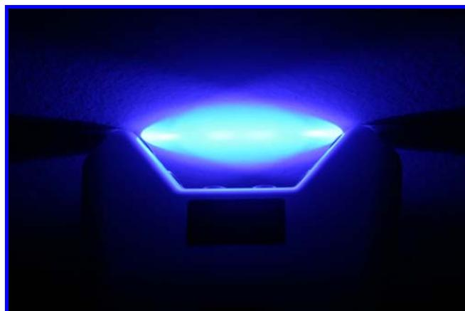
Figura 21 – Área de irradiação do aparelho na distância focal recomendada
