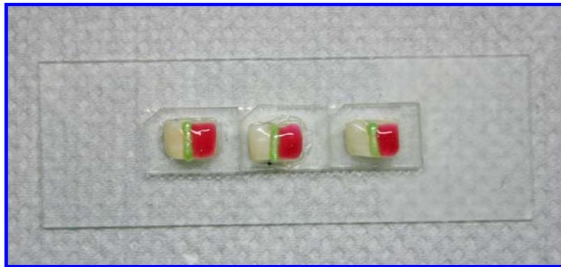
Figura 17 – Corpos-de-prova com o gel clareador aplicado no lado B. Aspecto inicial do gel, vermelho intenso.
