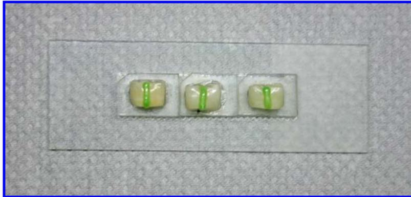
Figura 16 – Corpos-de-prova com a barreira de isolamento aplicada e polimerizada
