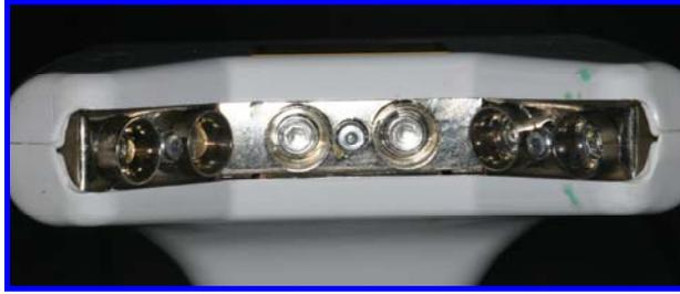
Figura 12 – Emissores de LED e Laser da peça de mão.
