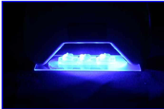
Figura 20 – Irradiação dos corpos-de-prova, três por vez para coincidir com a área de irradiação na distância recomendada.
