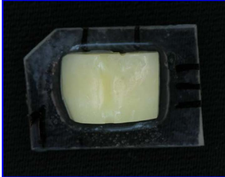
Figura 1 – Corpo-de-prova preparado, notar o desgaste oblíquo no canto superior esquerdo do mesmo e as marcações verticais (borda superior) e horizontais (borda lateral direita).
