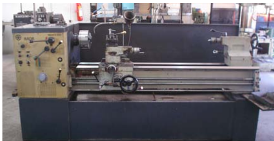
Figura 3.12 - Torno usado nos ensaios quick-stop
