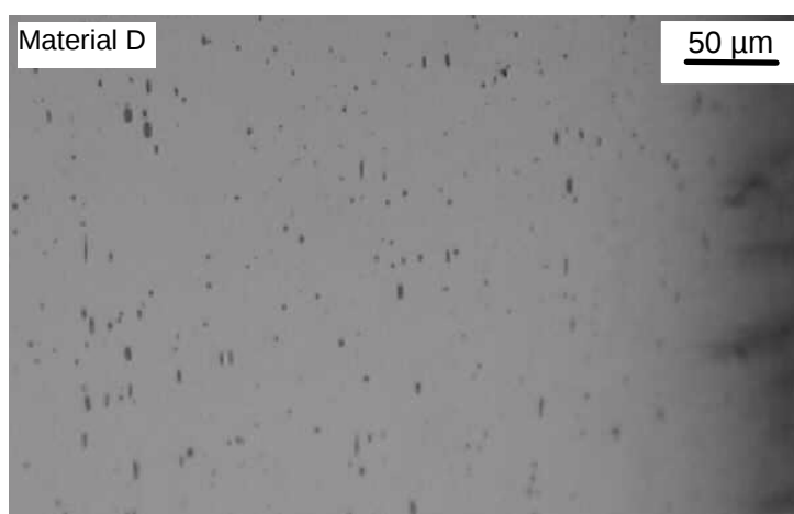
Figura 4.11 - Imagem representativa de inclusões na superfície do material D, seção longitudinal, aumento de 200X
