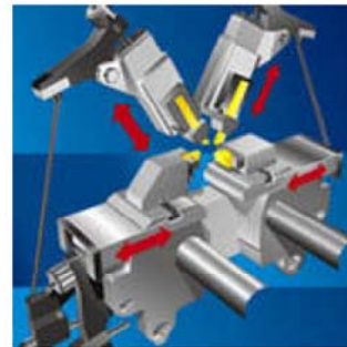
b) Movimentação dos cabeçotes durante a usinagem (FERRARI, 2003)
