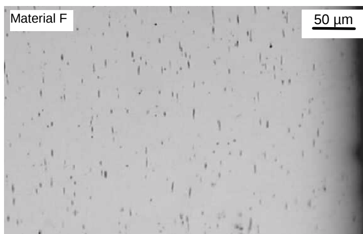
Figura 4.13 - Imagem representativa de inclusões na superfície do material F, seção longitudinal, aumento de 200X
