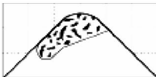
Figura 2.23 - Natureza fractal do contato cavaco-ferramenta (RAMAN et al., 2002)
