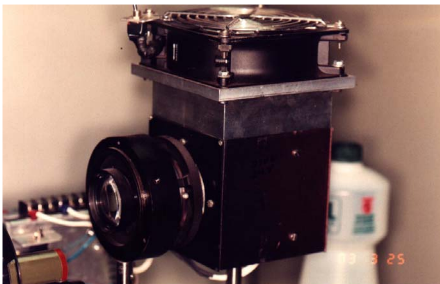
Fig.10 – Lâmpada de Tungstênio de 250W, fonte da luz geradora do sinal fotoacústico
