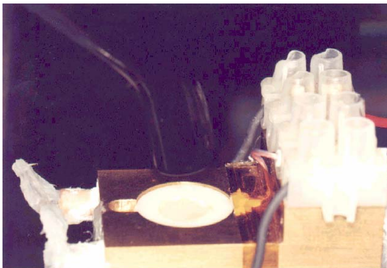
Fig 9. Ponta ativa do fotopolimerizador incidindo luz sobre a amostra de resina.
