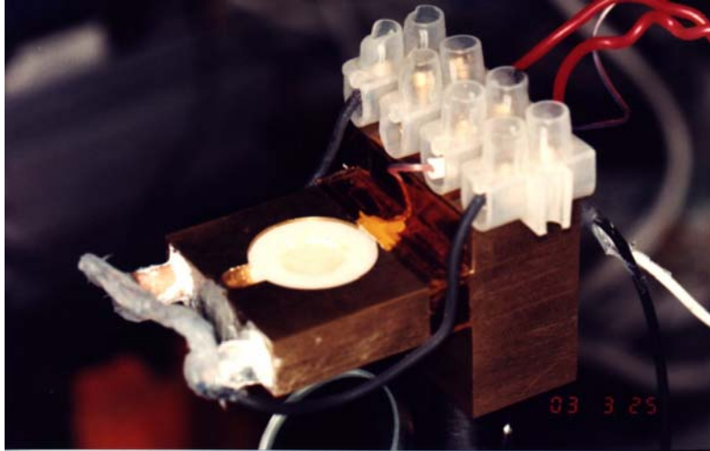
Fig.8. Célula fotoacústica com o molde em forma de disco
