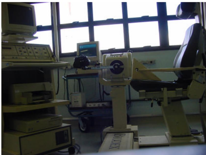
**Figura 2 – Equipamento de dinamometria isocinética utilizado. A foto foi tirada sem o atleta para melhor visualização da cunha que aumenta a flexão de coxo-femural**
