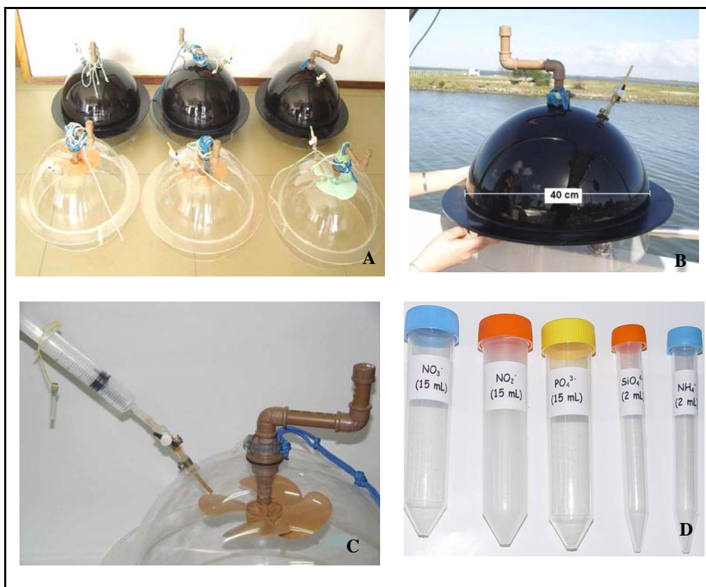
Figura 3: A - Câmaras transparentes e opacas utilizadas nas incubações in situ . B - Detalhe da câmara opaca. C - Retirada de amostra do interior da câmara utilizando seringas de 60 ml. D – Frascos de polietileno utilizados para o armazenamento das amostras.
