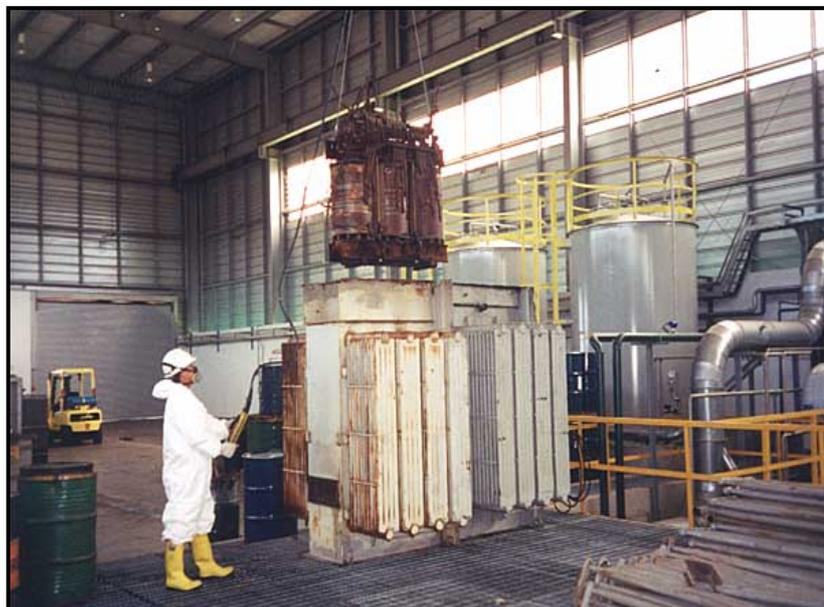
**FIGURA 7:** Processo de descontaminação de transformadores.
