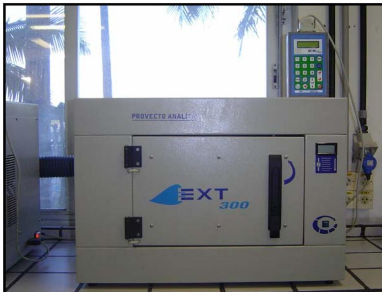
FIGURA 12: Extrator com microondas em tubo de Teflon fechado.
