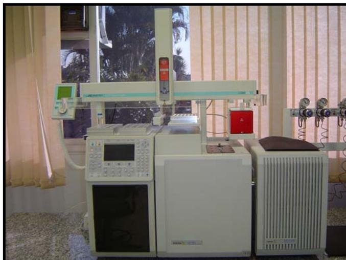
**FIGURA 11:** Cromatógrafo de fase gasosa equipada com Espectrômetro de Massas (CG/EM).
