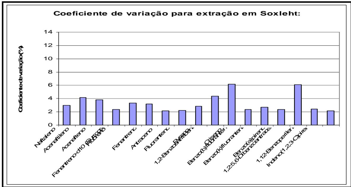
**FIGURA 38:** Gráfico do coeficiente de variação (RSD) para cada HPA estudado por a extração em Soxhlet.
