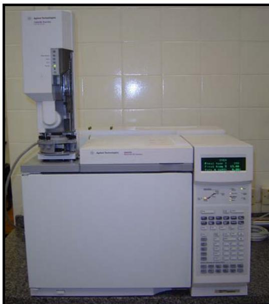
**FIGURA 10:** Cromatógrafo de fase gasosa equipado com  $\mu$ -detector de captura de elétrons (CG/ $\mu$ -DCE).
