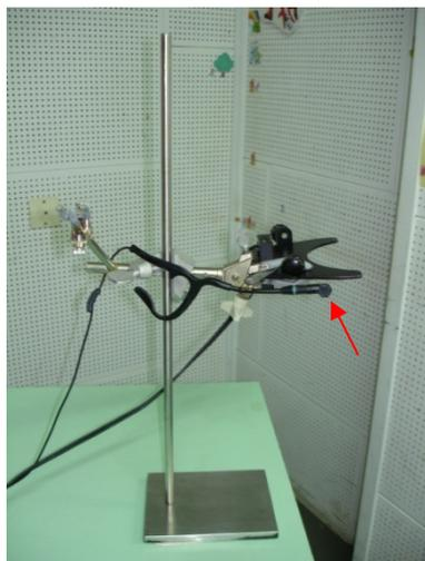
**Figura 3** – placa do nasômetro com microfone AKG C420 acoplado (adaptação Dutka 1992)
