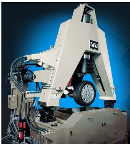
Figura 1.1 – Equipamento de medição de forças e momentos MTS – Flatrac.
