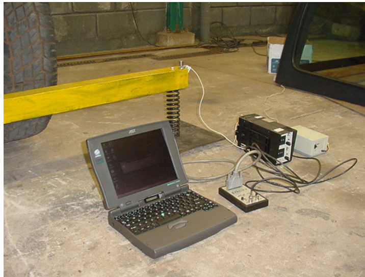
Figura 5.9 - Instrumentação usada no ensaio para determinação do momento de inércia.
