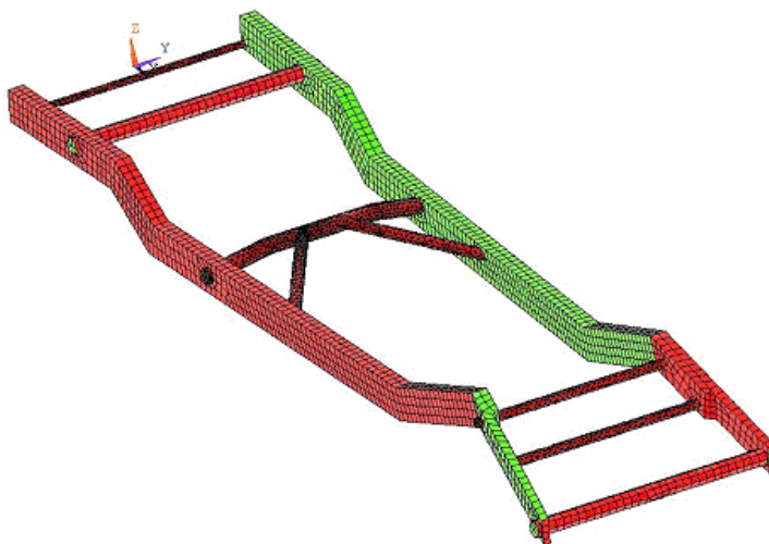
Figura 6.18 – Modelo de elementos finitos para o chassi (Pinto, 2003).
