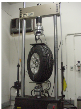
Figura 5.24 – Ensaio de compressão para o pneu.
