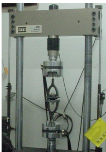
Figura 5.26 – Fixação do coxim através de dispositivos na MTS.
