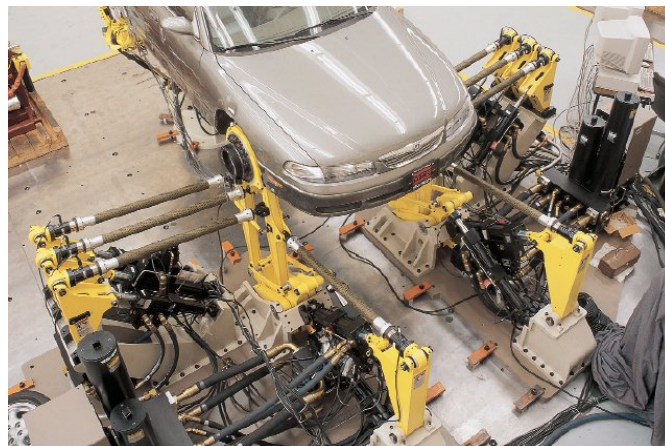
Figura 1.2 – Equipamento de determinação da cinemática da suspensão e direção.
