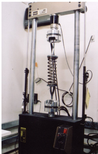
Figura 5.22 – Ensaio da mola traseira.
