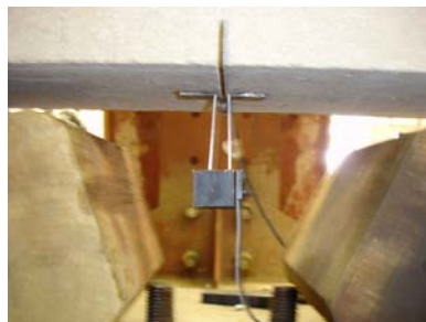
b) Clip Gauge usado para medir a abertura da fissura
