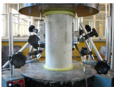
a) Ensaio do CP de 30MPa
