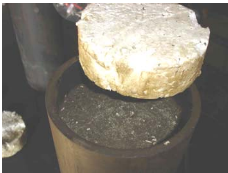
Figura 5.7 – Isopor utilizado para deixar a extremidade inferior livre para aplicar carga no concreto
