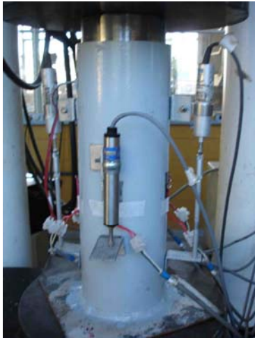
Figura 5.5 – Chapa de aço na base e carga aplicada no concreto apenas no topo
