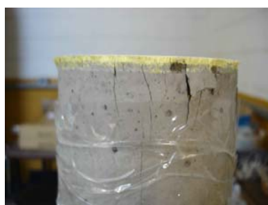
b) Esmagamento da região das extremidades do CP de 80MPa
