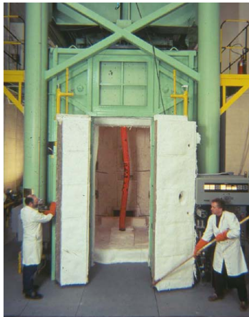
Figura 3.13 – Pilar misto preenchido logo após o ensaio em um forno (KODUR, 2006)
