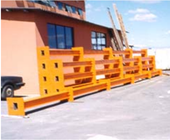
Figura 2.8 – Perfis prontos para serem levados à obra
