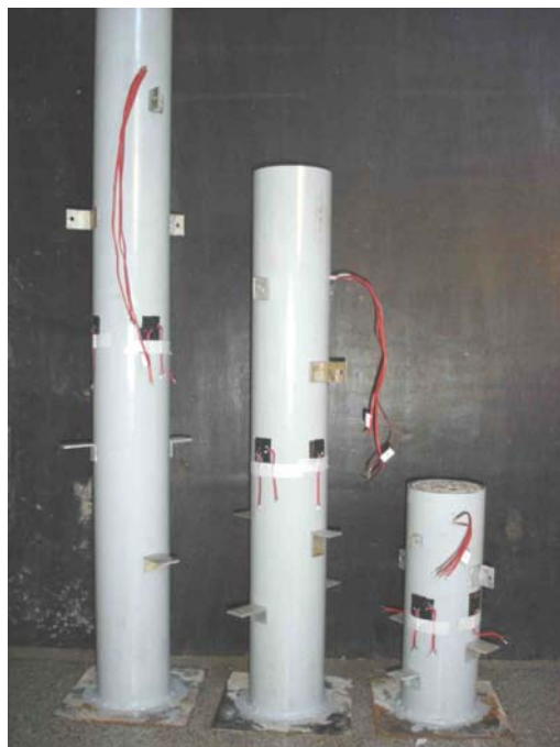
Figura 5.3 – Instrumentação nos pilares do ensaio piloto com L/D igual a 10, 7 e 3
