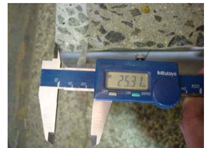
c) Medição da profundidade do entalhe após o ensaio
