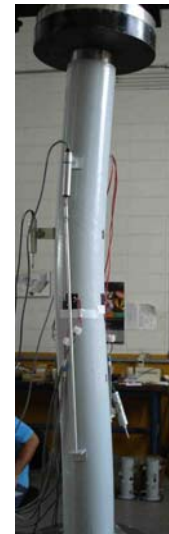
Figura 5.12 – Extremidade permitindo rotação
