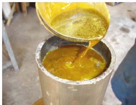
Figura 5.8 – Regularização da superfície com enxofre
