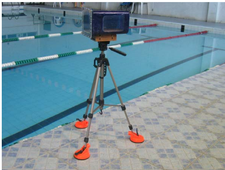
Figura 15 - Foto da caixa estanque como tripé para filmagem subaquática fixada ao suporte
