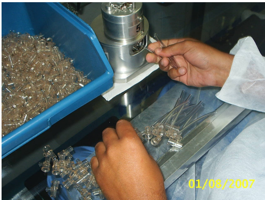
Figura 6.11 – Operação de colagem de componentes utilizando o dispositivo dosador de solvente – Vida Tecnologia Biomédica (2007)
