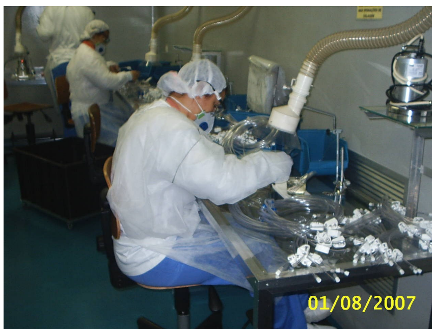
Figura 6.13 – Linha de produção celular do processo de montagem do produto final – Vida Tecnologia Biomédica (2007)
