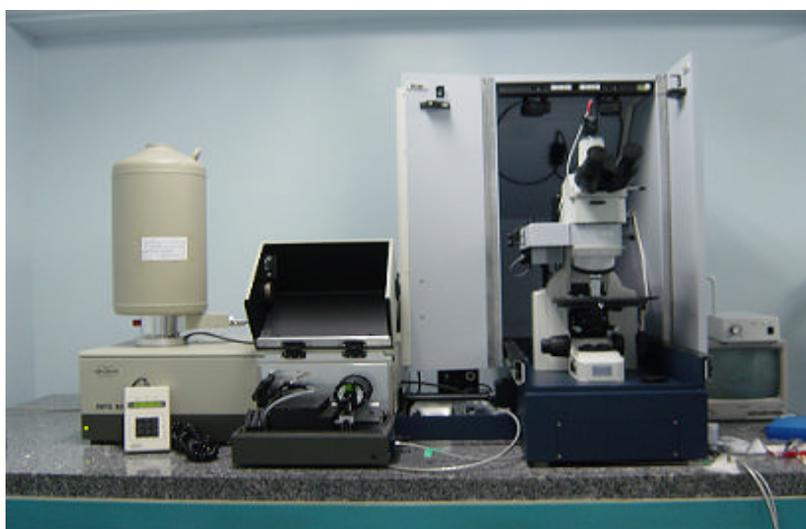
Figura 32 Aparelho Espectrômetro FT- Raman RFS 100
