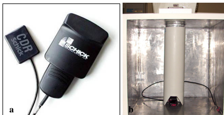
FIGURA 10 - (a) sensor radiográfico digital utilizado e (b) sensor acoplado paralelamente ao plano horizontal, dentro de caixa especial. A perpendicularidade sensor/feixe de raios-X foi sempre mantida.
