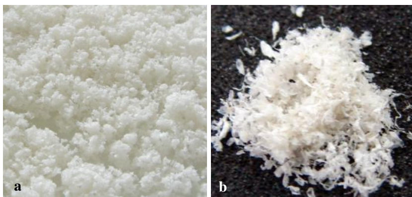
FIGURA 3 - (a) quitina em pó obtida durante a aplicação da metodologia e (b) quitosana em pó obtida a partir da quitina.
