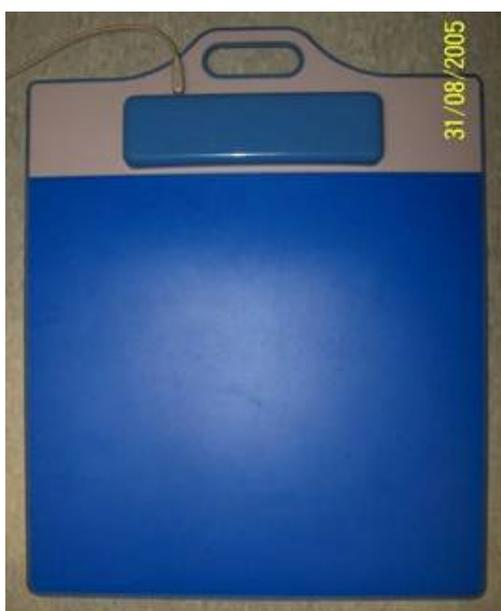
**FIGURA 4:** Plataforma de Força.
