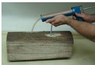
b) Utilização do aplicador adaptado
