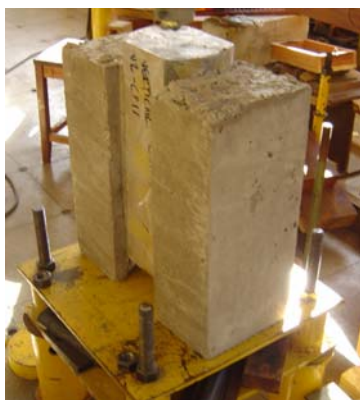
a) Corpo-de-prova misto para a realização dos ensaios
