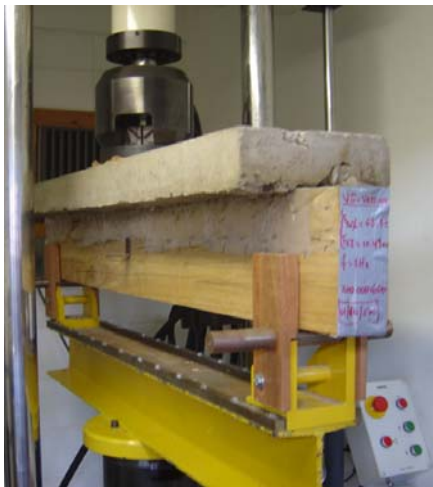
a) Detalhe da realização do ensaio dinâmico de flexão.
