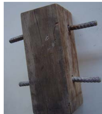
b) Flexão do conector e embutimento na madeira
