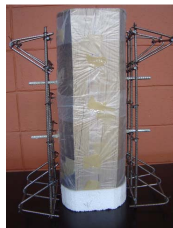
c) Vista dos conectores “verticais” de cisalhamento
