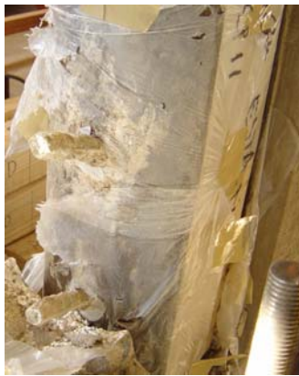
b) Flexão dos conectores após 2 \times 10^6 ciclos de carga aplicados (CP12-VR2)
