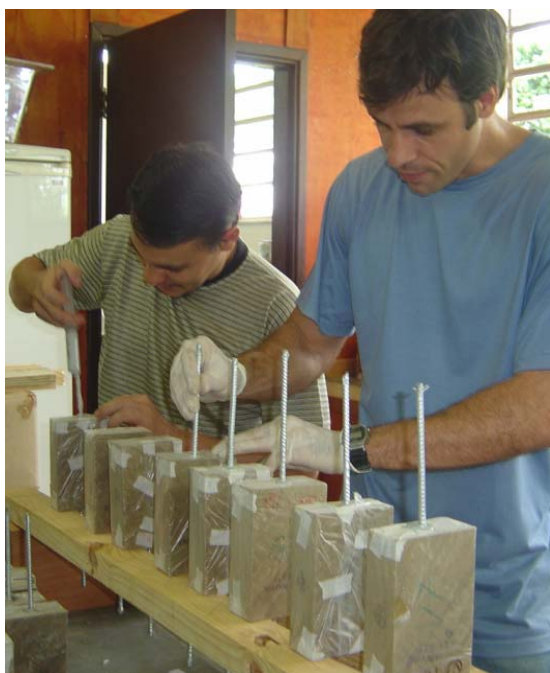
a) Fixação das barras de aço
