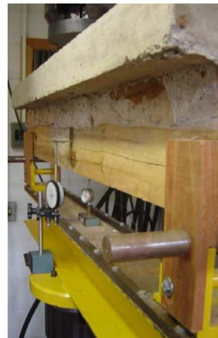
b) Detalhe do ensaio estático de flexão após os ciclos de carga.
