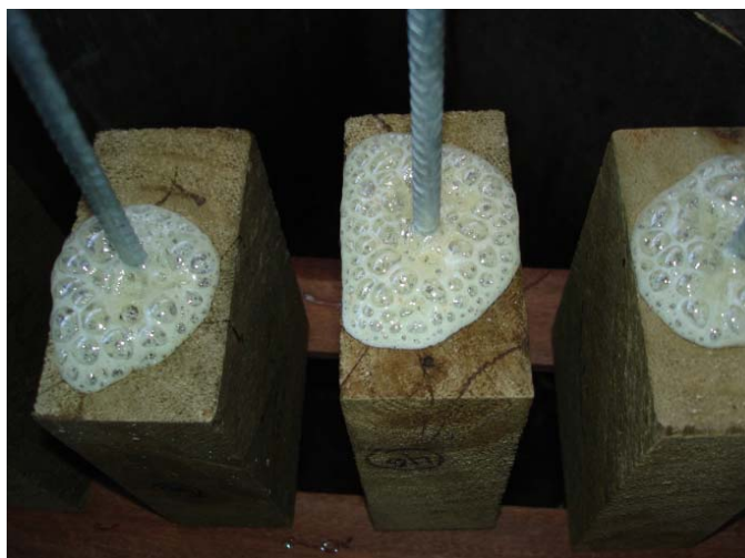
Figura 3.20: Incorporação de bolhas de ar na presença de umidade na madeira observada para a resina Purweld 665.
