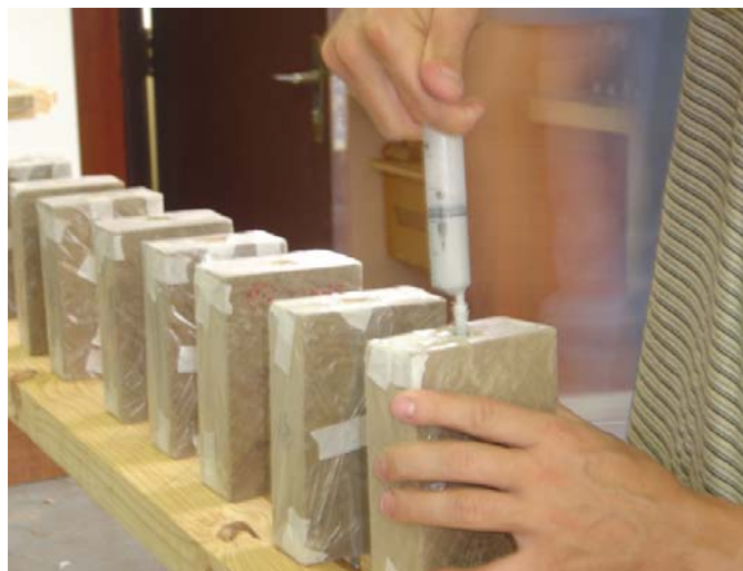
Figura 3.5: Aplicação das resinas epóxis Compound Adesivo e Sikadur 32.
