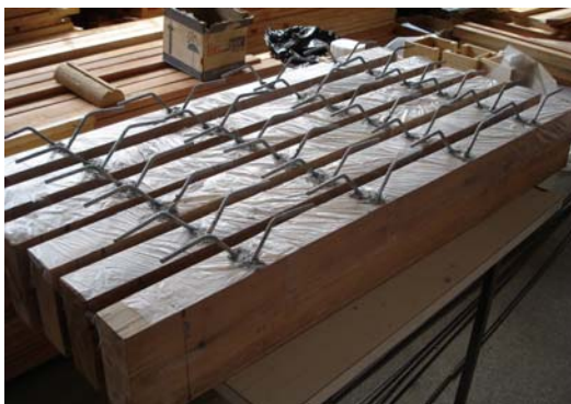
a) Conectores em “X” após a colagem
