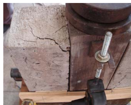
b) Fissuração no concreto após a aplicação dos ciclos de carga
