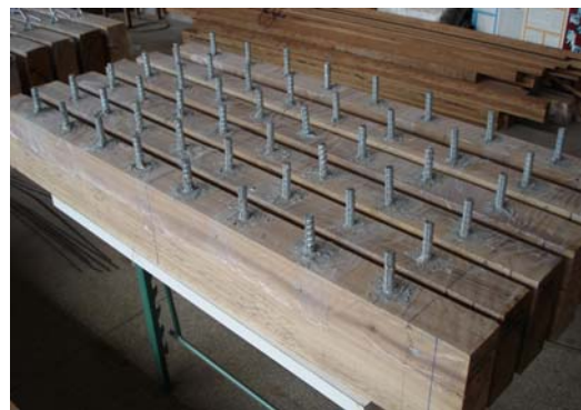
b) Conectores “verticais” após a colagem
