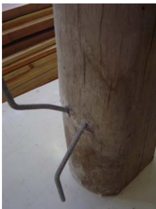
a) Situação dos conectores “X” após 2 \times 10^6 ciclos de carga (CP09-VR2).
