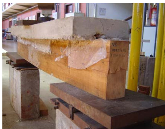
a) Ruptura na alma da viga mista por cisalhamento na LN
