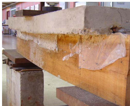
b) Ruptura da viga mista por cisalhamento na LN, após 1 \times 10^6 ciclos, conduzida até a falha.
