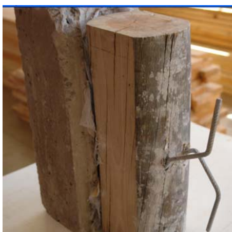
a) Detalhe do conector “X” após o ensaio estático de cisalhamento até a ruptura.
