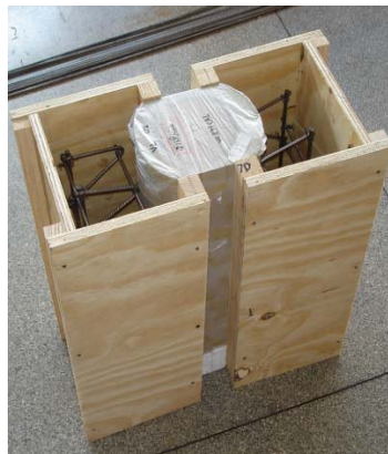
b) Detalhe da fôrma utilizada para o concreto
