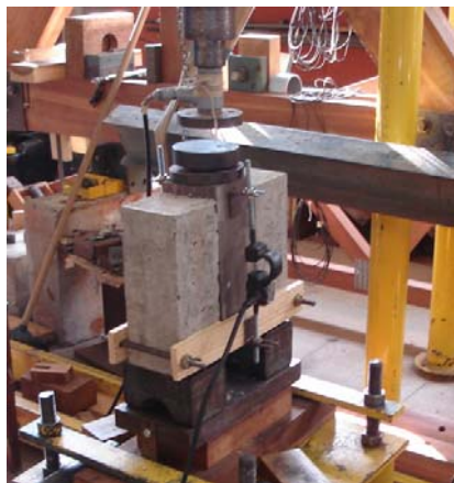
a) Instrumentação do corpo-de-prova no pórtico de reação
