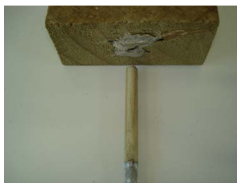
(b) Ruptura da adesão na madeira.
