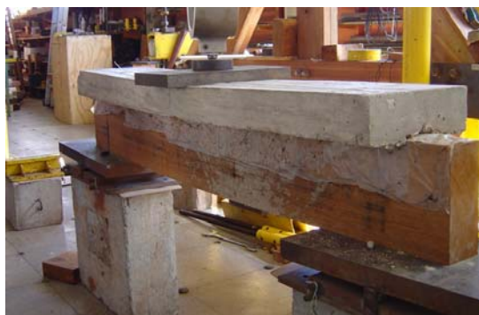
b) Ruptura última por cisalhamento na LN, após 1 \times 10^6 ciclos de carga.
