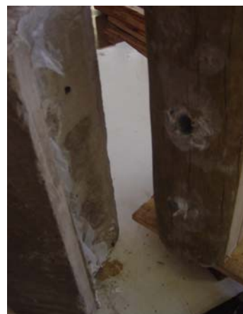
b) Ruptura da barra de aço após 768.089 ciclos de carga – comportamento observado no ensaio dinâmico do CP01-VR1 para carga cíclica máxima aplicada de F_{50\%}
