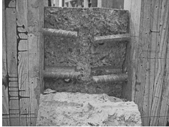
Figura 2.31: Modos de falha observados nos corpos-de-prova. Fonte: (Modificado de Weaver 2004).
