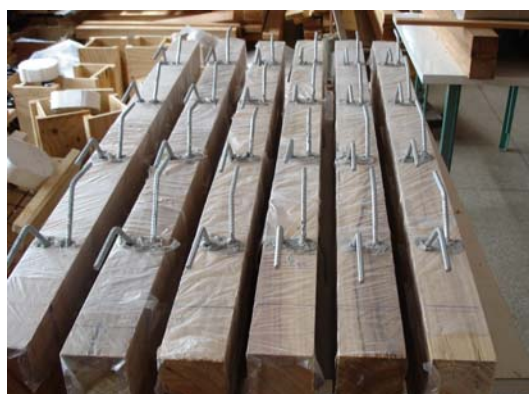
a) Vista dos conectores dispostos em “X” na interface dos materiais
