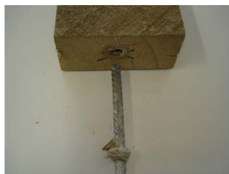
(d) Ruptura da adesão na face do aço com arrancamento da madeira na extremidade do furo.
