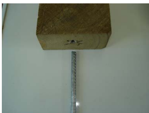
(a) Ruptura da adesão no aço.
