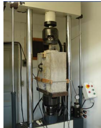
b) Ensaio dinâmico de cisalhamento
