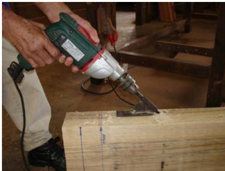
a) Gabarito de furação das vigas
