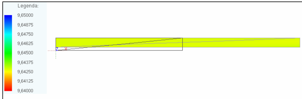
Figura 8.14 - Valores da tensão longitudinal real obtidos com a simulação da casca sob tração uniaxial no último passo de carga (tensão de engenharia \sigma = 5,0 MPa)
