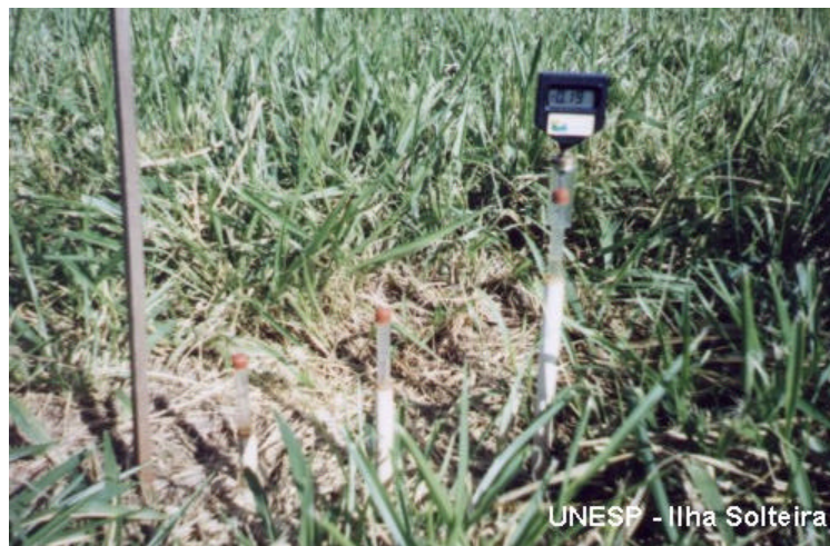
Figura 8. Visão geral das baterias de tensiômetros.
