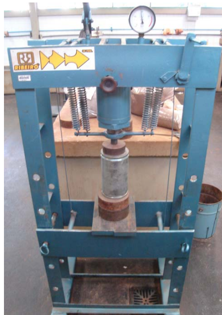
Figura 4.12 - Prensa Hidráulica utilizada na moldagem dos corpos-de-prova para o ensaio Triaxial Dinâmico.
