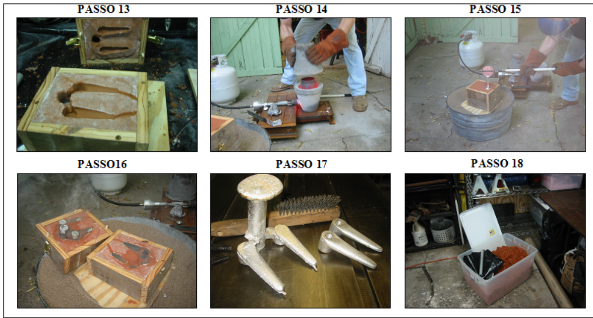
Figura 2.5 – Exemplo de Moldagem de uma peça, passos 13-18. ( www.backyardmetalcasting.com ; 26/10/2007)
