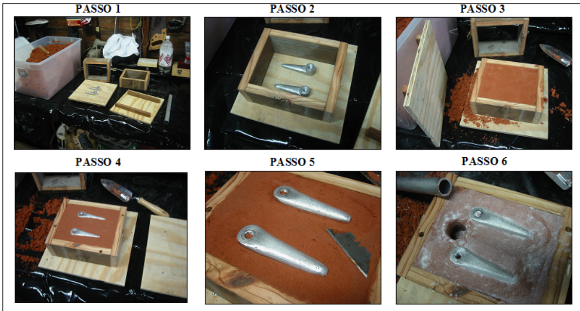
Figura 2.3 – Exemplo de Moldagem de uma peça, passos 1-6. ( www.backyardmetalcasting.com ; 26/10/2007)
