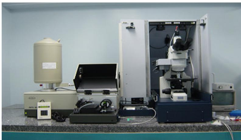
Figura31 - Espectrômetro FT-Raman RFS 100, Bruker.
