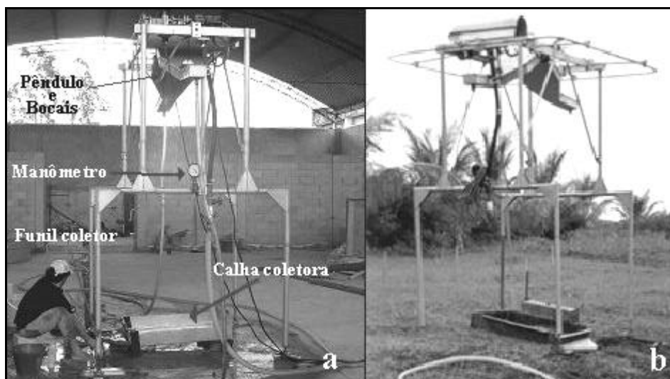
Figura 2. Instalação do simulador de chuva em laboratório (a) e no campo (b).
