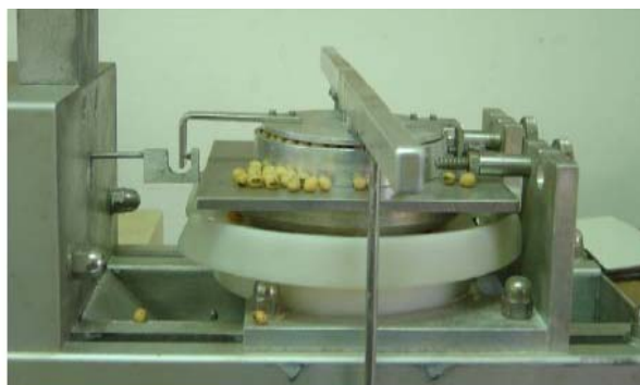
Figura 6.9 - Ensaio de cisalhamento direto com a parede com o aparelho de Jenike modelo TSG 70-140.
