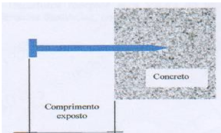
Figura 5.8 – Leitura do comprimento exposto do pino
