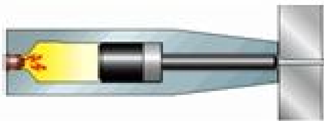
Figura 5.6 – Ação da pólvora na câmara interna da pistola diretamente no pino
