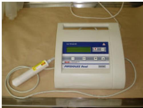
**Figura 2-** Equipamento Laser Physiolum Dual da Bioset – Al-Ga-As com comprimento de onda de 785 nm.
