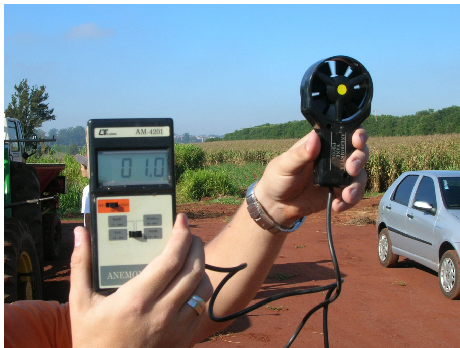
Figura 6 – Anemômetro digital portátil Lutron modelo AM-4201.
