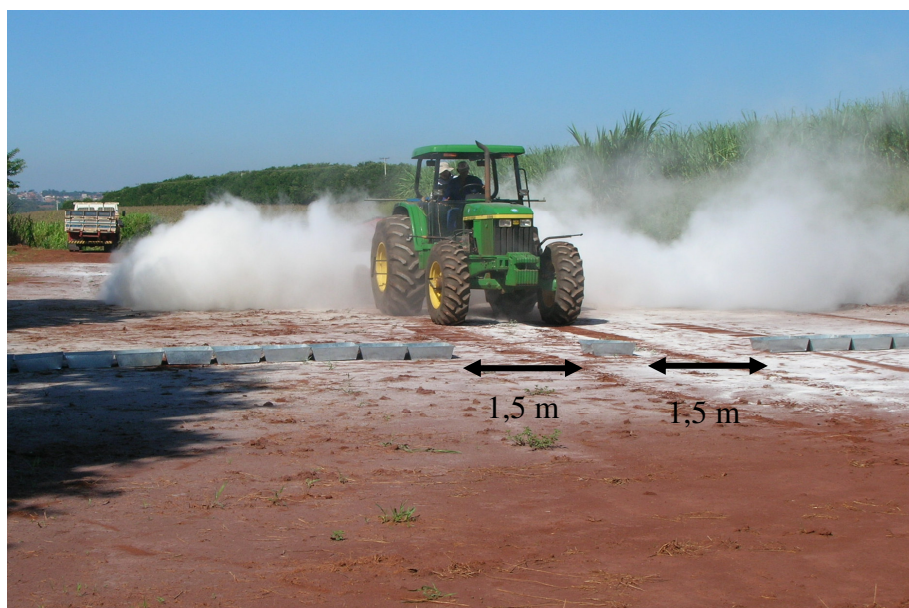
Figura 9 – Passagem do distribuidor sobre os coletores.
