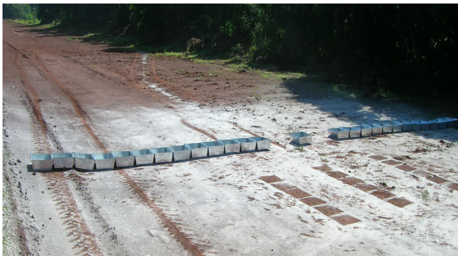
Figura 10 – Vista geral dos coletores distribuídos na pista de ensaio.
