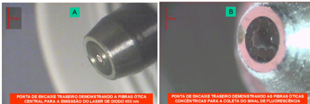
FIGURA 25 A e B: encaixe metálico que contém fibras óticas que são conectadas na parte traseira do Diagnodent ® , mostrando uma fibra emissora (A) e nove fibras coletoras (B), microfotografado no laboratório do Prof. Zângaro, no IP&D.
