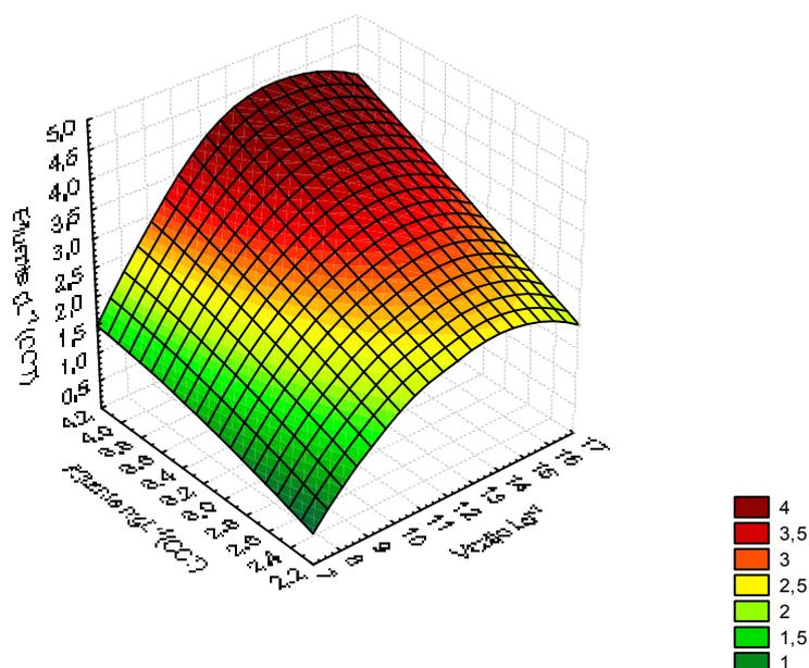
**Figura 13** – Gráfico para os valores de carbono orgânico total do efluente em função da vazão e do carbono orgânico total do afluente no reator acidogênico.
