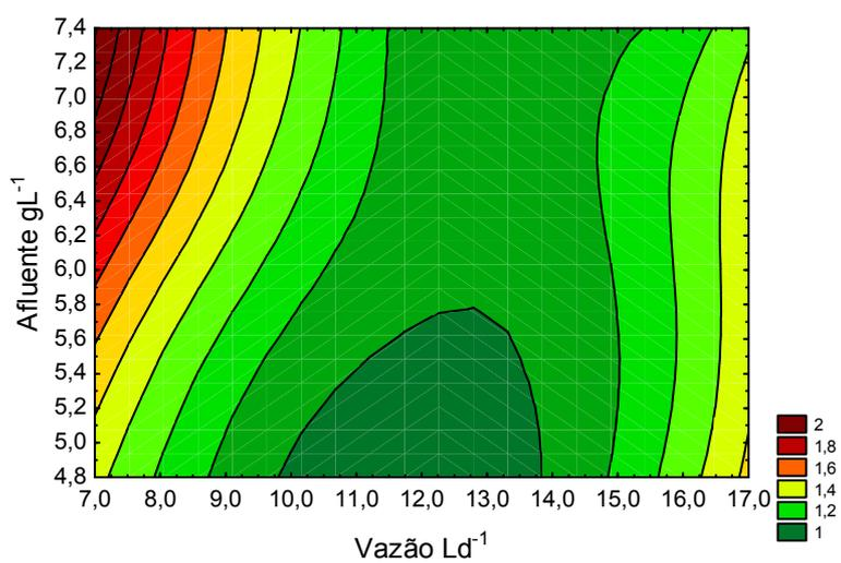
**Figura 22:** Gráfico das curvas de contorno para os valores de concentração de sólidos voláteis do efluente em função da vazão de alimentação e da concentração de sólidos voláteis do afluente no conjunto de reatores.
