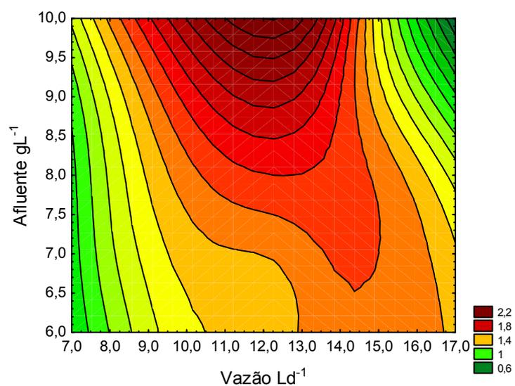
**Figura 20:** Gráfico das curvas de contorno para os valores de concentração de sólidos totais do efluente em função da vazão de alimentação e da concentração de sólidos totais do afluente no conjunto de reatores.
