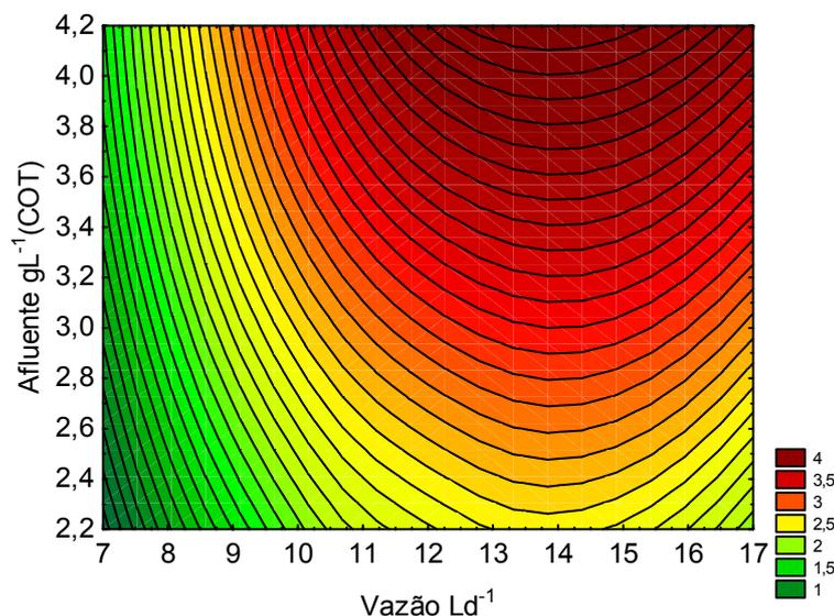
**Figura 14** – Gráfico das curvas de contorno para os valores de carbono orgânico total do efluente em função da vazão e do carbono orgânico total do afluente no reator acidogênico.
