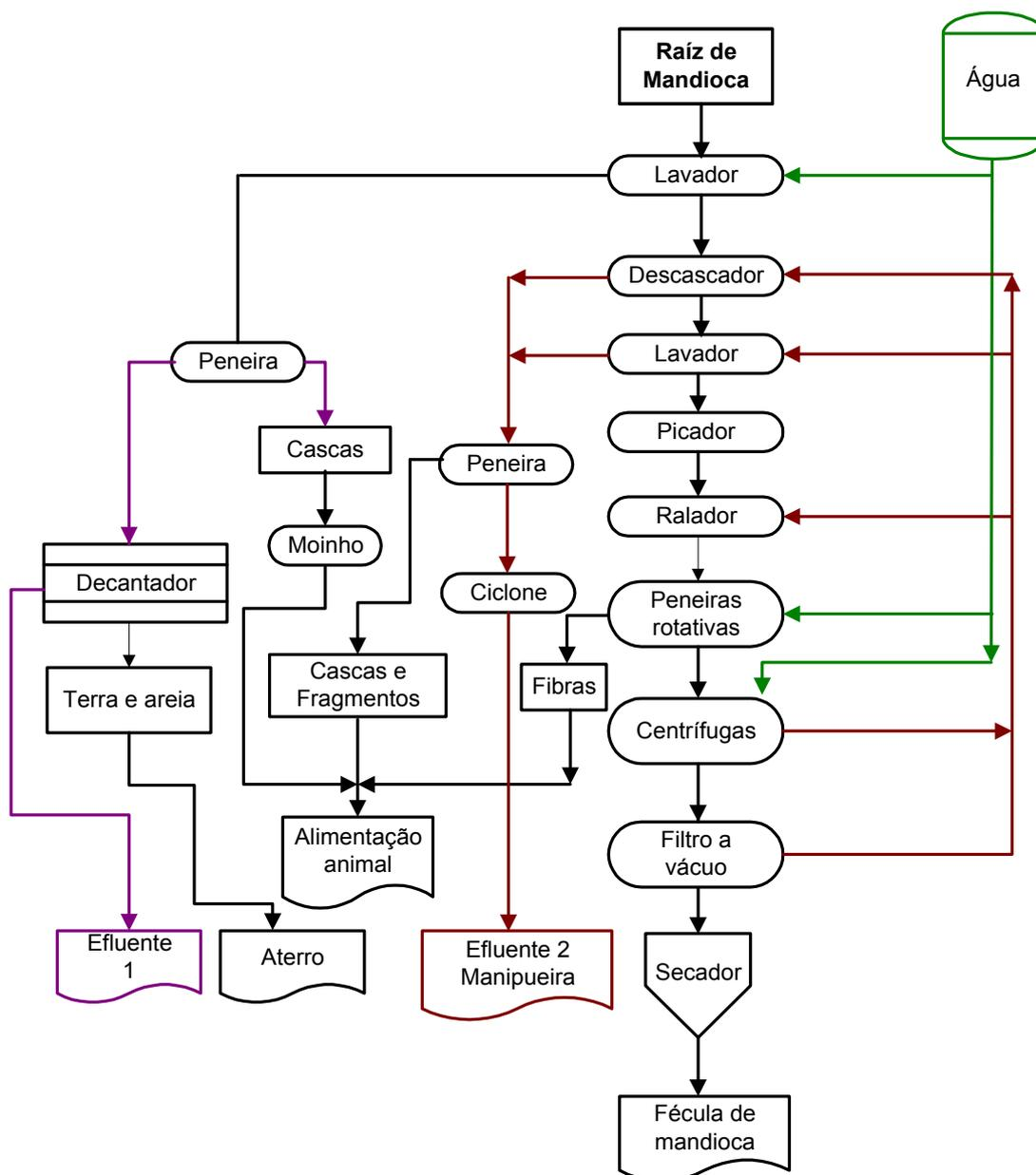
**Figura 7:** Fluxograma de processamento da fécula de mandioca.
