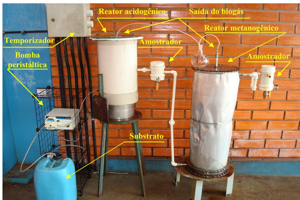
**Figura 11:** Reatores de digestão anaeróbia
