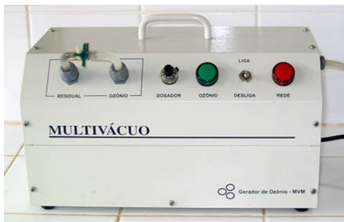
Figura 3 – Equipamento gerador de ozônio.
