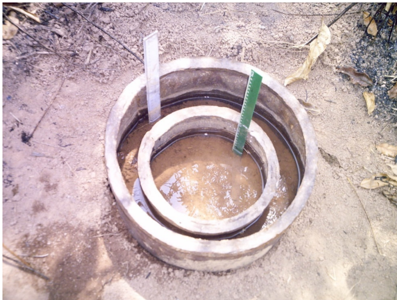
Figura 17 - Infiltrômetro concêntrico de anéis.
