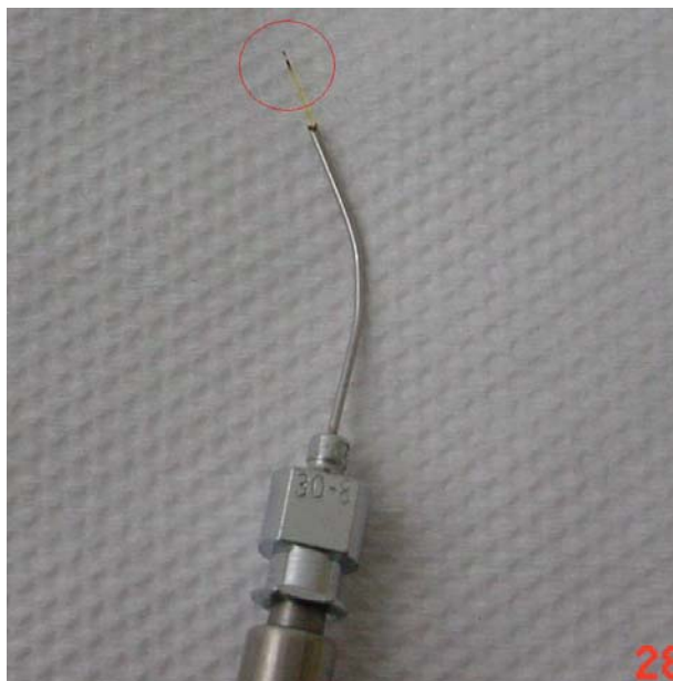
Figura 13 – Fibra óptica de sílica.
