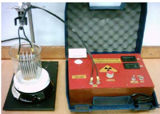
Figura 18 – Unidade piloto de eletrofloculação (Cerqueira, 2006)
