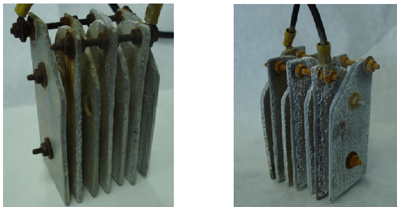
Figura 23 – Eletrodo antes (E) e depois da eletrofloculação (D) - deposição de sais.
