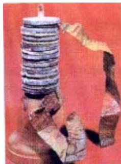
Figura 1 – Pilha de Volta (Sardella, 2002)
