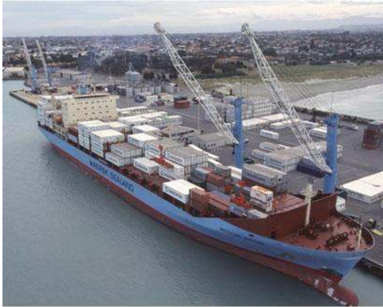
Figura 2.13: Operação de Navio com MHC ( Mobile Harbor Crane )
