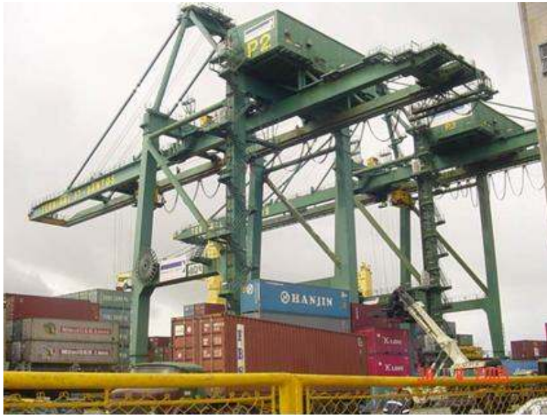
Figura 2.14: Operação de Navio com Portêiner (QC – Quay Crane)
