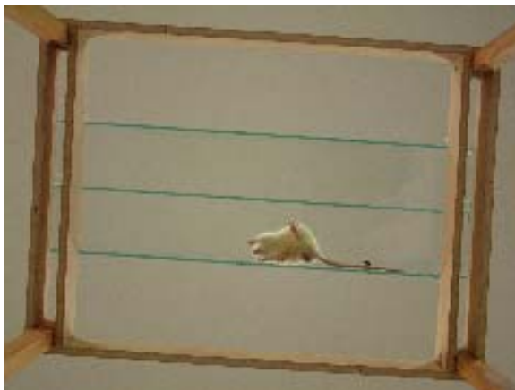
Figura 10 – Câmara de observação para avaliação do tremor espontâneo das patas. Vista inferior.
