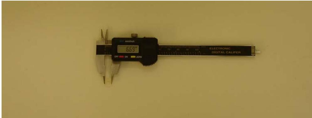
Figura 4.8 - Paquímetro eletrônico digital Caliper - Marel (0 - 100mm) registrando o diâmetro inicial de um anel elástico.
