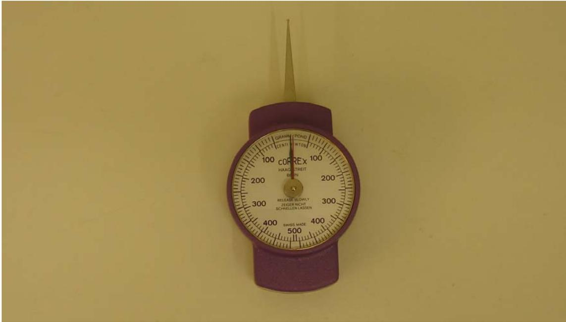
Figura 4.2 - Fotografia do dinamômetro Haag-Streit A.G. Correx (50-500g)
