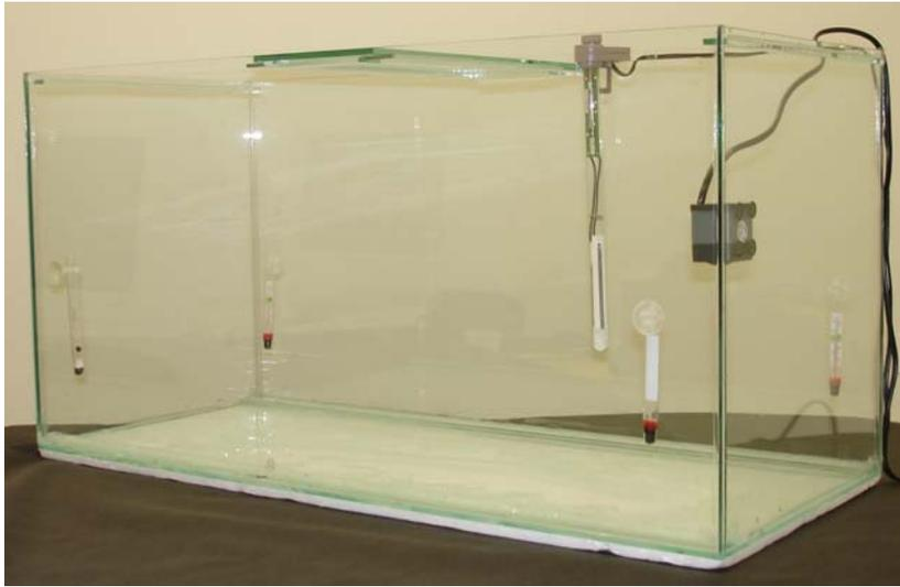
Figura 4.7 - Recipiente preparado para o experimento. Notar a presença do termostato (parede ao fundo), da motobomba (parede direita), e dos 4 termômetros (nos quatro cantos do recipiente).
